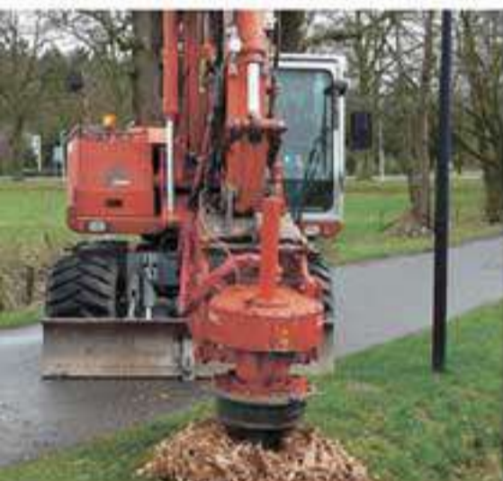
АГРЕГАТИРОВАНИЕ НА СТРЕЛУ ЭКСКАВАТОРА, РАБОТАЕТ ОТ ГИДРОСИСТЕМЫ
