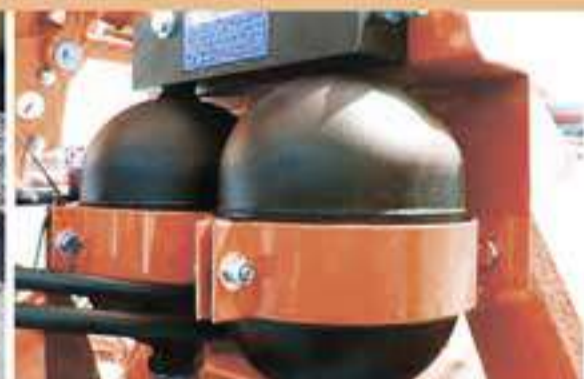
ОХЛАЖДЕНИЕ ГИДРАВЛИКИ, АЗОТНЫЙ АККУМУЛЯТОР
