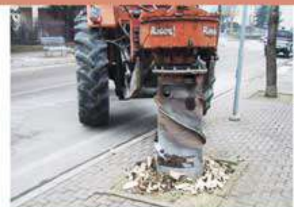
ЦИЛИНДРИЧЕСКИЙ РАБОЧИЙ ОРГАН ДЛЯ ИЗВЛЕЧЕНИЯ СТЕРЖНЯ ПНЯ
