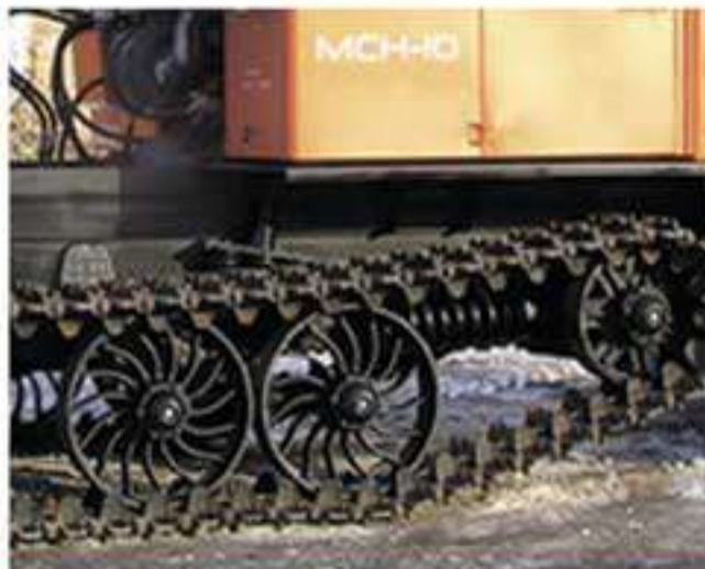
РЫЧАЖНО – БАЛАНСИРНАЯ ПОДВЕСКА
