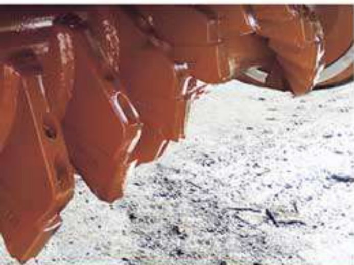
ФИКСИРОВАННЫЕ ЗУБЬЯ С ДВОЙНЫМИ КРЕПЛЕНИЯМИ
